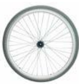
// BRS070070 Заднее колесо 22", литое, 36 спиц (серебристые), перекрещивающиеся спицы, обруч алюм., анодированный, серебристый
